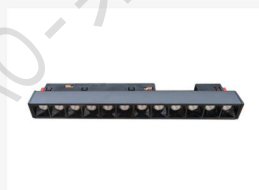
型号: G002 名称: 12头12W调光调色温格栅灯 规格: 输入电压: 38V, 功率: 12W, 流明: 840LM, 显指: RA≥90, 光束 角: 24°尺寸: L220*W22*H44mm
