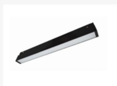
型号: D001 名称: 7W面光 规格: 48V, 294*22*43mm, 黑色, 480LM, 显指>90
